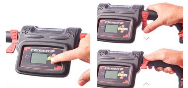
**Azionamento console.** Accendere la console premendo qualsiasi tasto della maschera di interfaccia. Premere le leve a farfalla verso il basso o verso l'alto per movimentare i cingoli.
