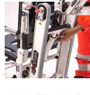
**Aprire i cingoli** Sbloccare il carrello cingolato agendo sulla leva posta in prossimità del pistoncino meccanico posteriore e abbassando fino a completa apertura.
