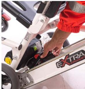
**Installazione batteria** Applicare la batteria, precedentemente ricaricata, sulle apposite guide.
